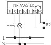
La lumière peut être allumée ou éteinte manuellement en fonction des besoins grâce à la commande à poussoir (Attention: les boutons poussoir lumineux sans neutre ne peuvent pas être gérés).
