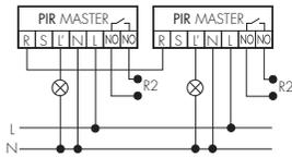
Subdivision d'une grande zone de détection en différentes zones d'éclairage avec mesure individuelle de la luminosité.
