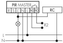
En cas d'enclenchement d'inductances parallèles au réseau (lampes fluorescentes, relais, etc.), un circuit RC peut être nécessaire.
